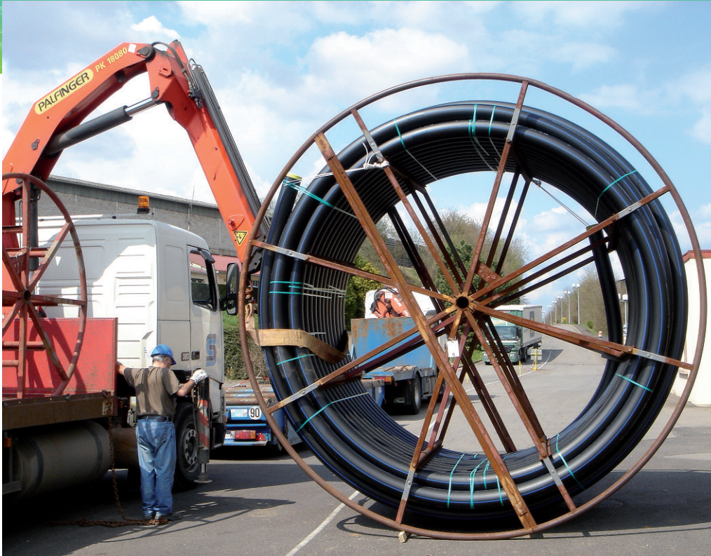
Ces tubes PE sont conditionnés en tourets et livrés en grandes longueurs.
